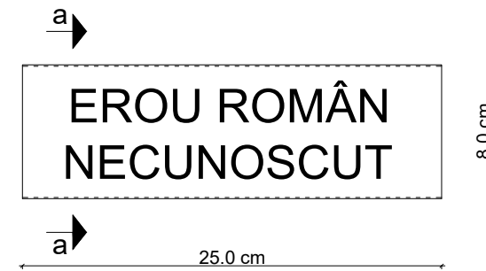
Placa metalica - Tabla metalica 1.2 mm x 80 mm x 250 mm - 8 buc. SCARA 1 : 5
