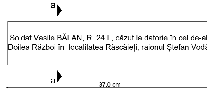
Placa metalica - Tabla metalica 1.2 mm x 80 mm x 250 mm - 8 buc. SCARA 1 : 5
